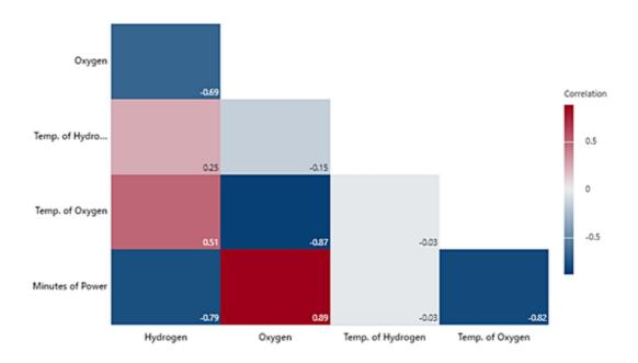
您是否注意到您的眼睛有多快看到圖形底下氧氣量 (Oxygen) 和發電分鐘數 (Minutes of Power) 的深紅色方框?使用 Correlograms 相關圖,顏色的深度與相關性成正比,方框顏色越深則表明相關性越強。因此,這個 Correlogram 相關圖提供了清晰可見、一目了然的相關係數的視覺化呈現。藉由這種情況下繪製 Correlograms 相關圖,工程師可以更輕鬆得理解數據中的相關性。
