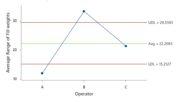
在這個 ANOME 範例中,不同操作員的量測結果傾向於高於或低於彼此。將不同操作員的平均量測值拉近,將改進量測系統。
